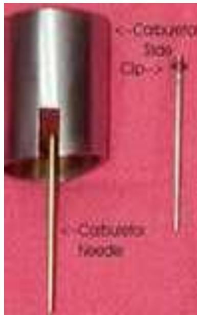
Hình 2.4: Kết cấu của kim ga và piston ga [23]
