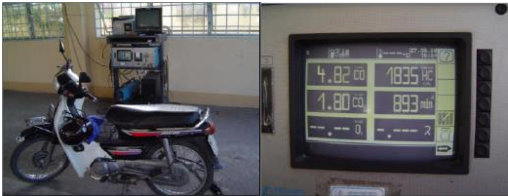
Hình 4.3: Đo khảo sát mức ô nhiễm xe Honda Astrea 100
