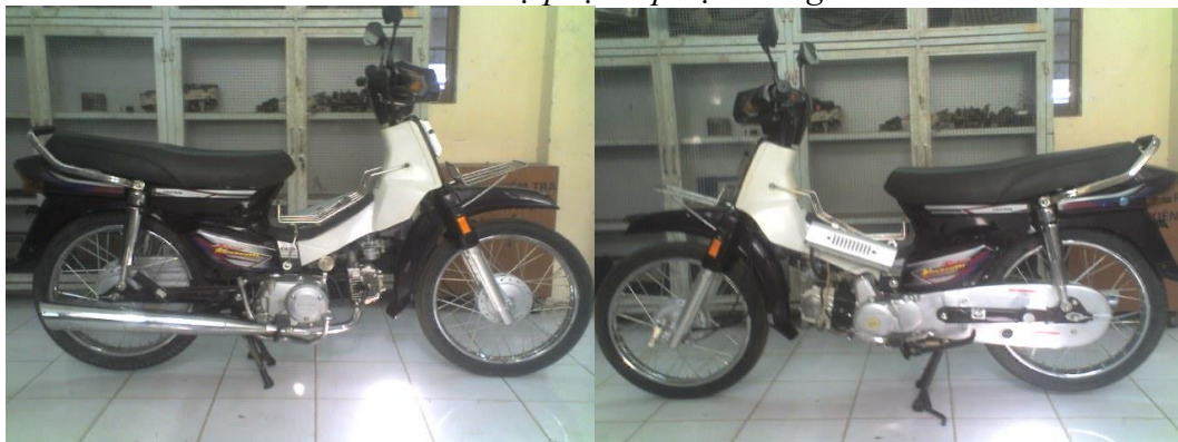
Hình 5.39: Xe Super Kuzomi sau khi lắp đặt các bộ phận của hệ thống phun LPG
