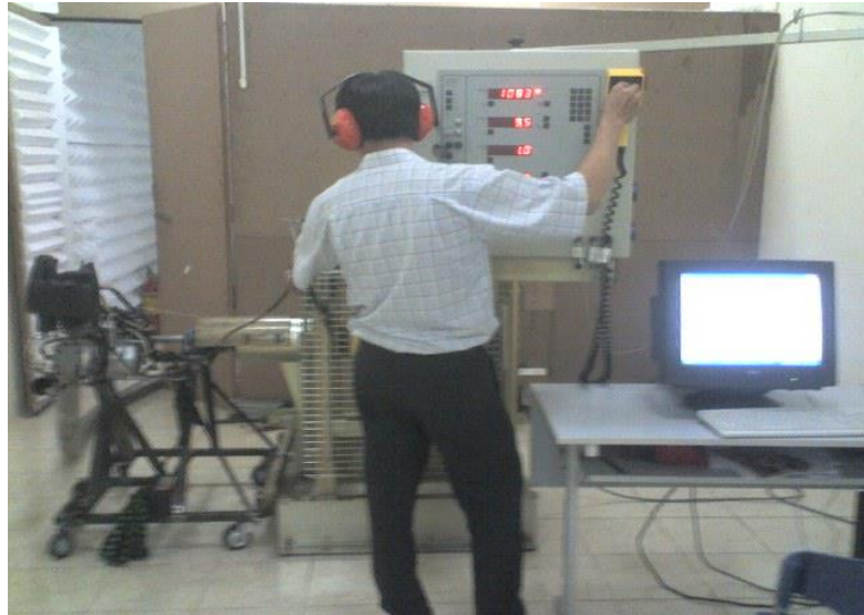
Hình 6.3: Tăng tải để xác định momen và công suất của động cơ
