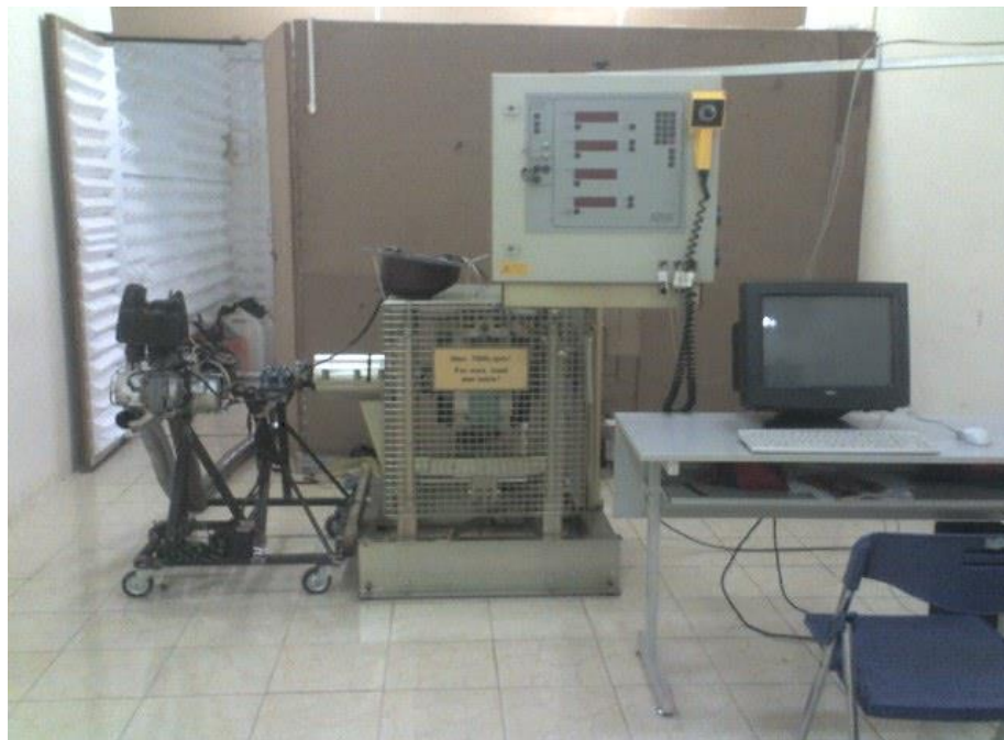
Hình 6.1: Động cơ thực nghiệm kết nối với thiết bị thí nghiệm động cơ Weinlich MP 100S
